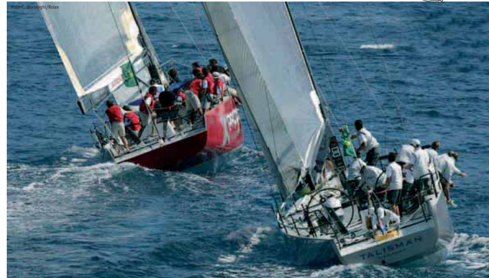
Sopra, due scafi da regata di nuova generazione (Botin&Carkeek Design) dove si notano i ridottissimi bagli massimi in rapporto alla lunghezza fuori tutto. A destra, l'equipaggio sporgendosi sopravvento sfrutta al massimo la stabilità di forma della barca
