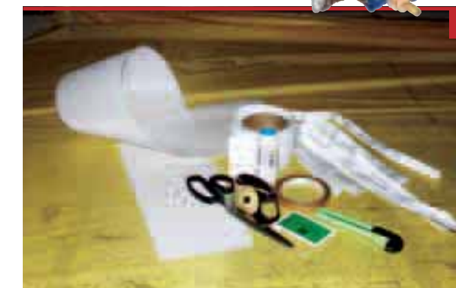
Il set per riparare una vela in emergenza è composto da: Forbici da sarto, salvapalmo, biadesivo piccolo, nastro adesivo forte, taglierino, ago da velaio, filo cerato medio, tela da vela
