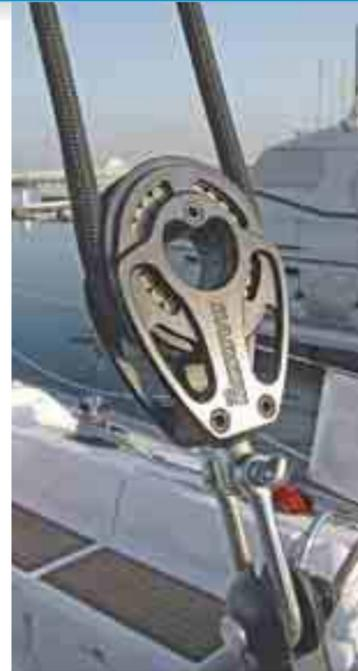
*Particolare di un paterazzo di un moderno fast-cruiser. In questo caso la cima utilizzata è in Vectran ricoperto con una calza in poliestere*
