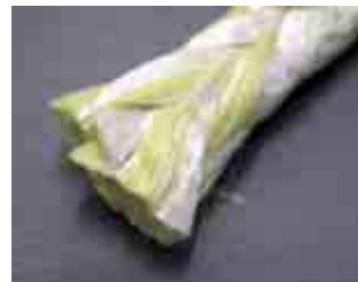
*Dyneema e Kevlar insieme. Il "creep" è inferiore rispetto ad una cima prodotta totalmente in Dyneema, ma è più pesante e non totalmente idrorepellente*
