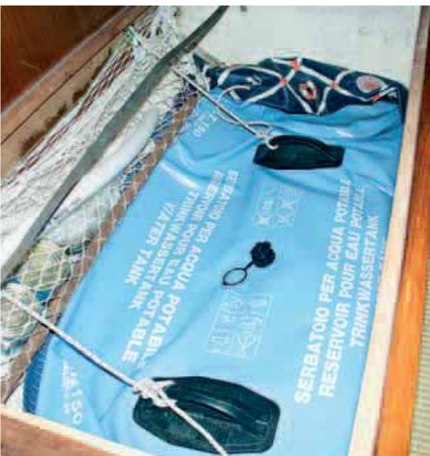
Sopra un serbatoio in acciaio protetto con della vetroresina. Sotto un serbatoio in Pvc morbido, la plastica blu che si vede in fondo al gavone serve a proteggere il serbatoio dalle pagliuzze di mat.
