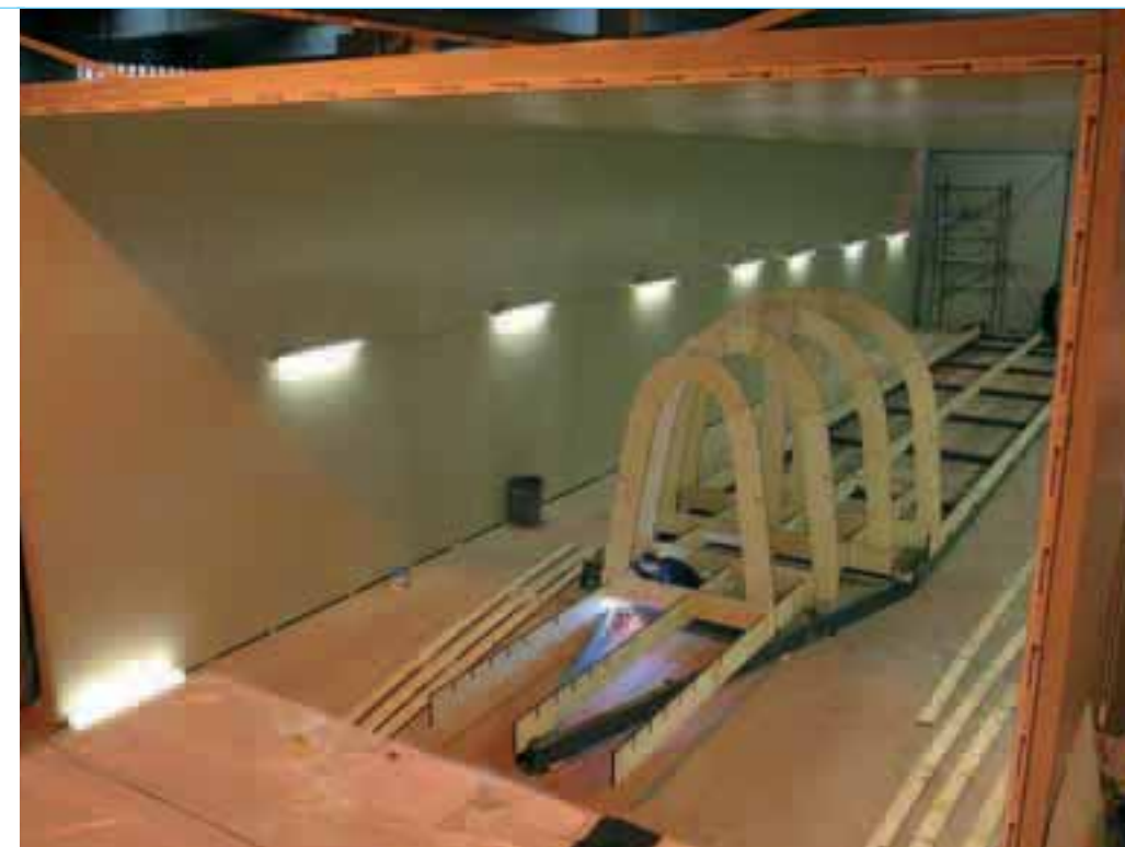
Sopra, un grande forno per la post cottura dei manufatti nel quale, viste le dimensioni, è possibile portare a elevate temperature anche maxi-yacht interamente realizzati in Prepreg. A destra in alto, si stende la pellicola che costituisce il sacco, utile a portare sottovuoto la stratificazione. A lato, anche per le parti di dimensioni ridotte, si applica il sacco per portare sottovuoto il Prepreg
