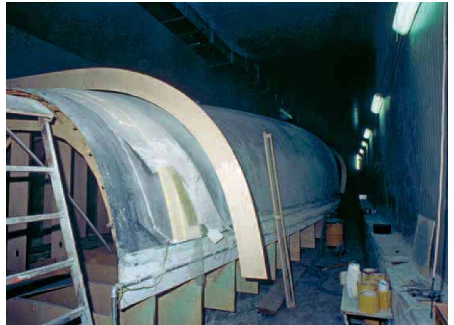
All'interno del forno, poco prima del trattamento di post cottura, che deve avvenire con il manufatto ancora sullo stampo
