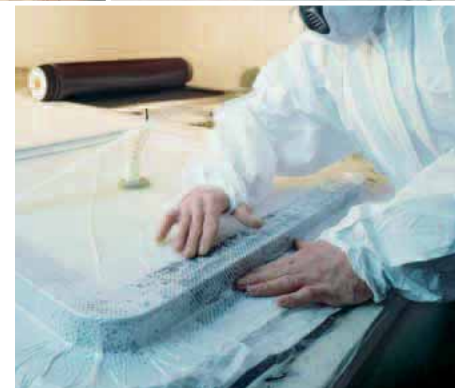
Sopra, un grande forno per la post cottura dei manufatti nel quale, viste le dimensioni, è possibile portare a elevate temperature anche maxi-yacht interamente realizzati in Prepreg. A destra in alto, si stende la pellicola che costituisce il sacco, utile a portare sottovuoto la stratificazione. A lato, anche per le parti di dimensioni ridotte, si applica il sacco per portare sottovuoto il Prepreg
