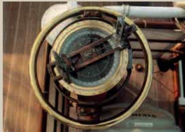
Sopra, una bussola italiana del XVI secolo. A sinistra, bussola inserita in una chiesuola d'ottone. Sotto, bussola giroscopica particolarmente stabile, ottima da rilevamento
