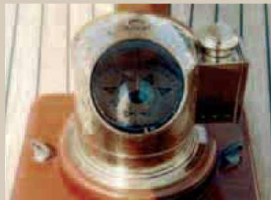
Sopra, una bussola italiana del XVI secolo. A sinistra, bussola inserita in una chiesuola d'ottone. Sotto, bussola giroscopica particolarmente stabile, ottima da rilevamento
