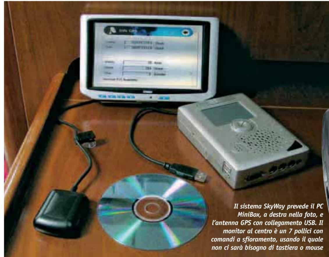
*Il sistema SkyWay prevede il PC MiniBox, a destra nella foto, e l'antenna GPS con collegamento USB. Il monitor al centro è un 7 pollici con comandi a sfioramento, usando il quale non ci sarà bisogno di tastiera o mouse*
