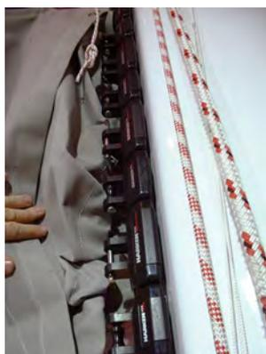
● Sopra, due vecchi monoscafi di Coppa America. Queste barche montano delle rande steccate molto sofisticate con stecche di carbonio e dei fiocchi con stecche pneumatiche. Di lato, una batterie di carrelli con sfere della Harken per le rande steccate. Questo tipo di carrelli ormai è superato ma, quando uscirono sul mercato furono una rivoluzione, si riusciva ad ammainare una randa anche stando al lasco
